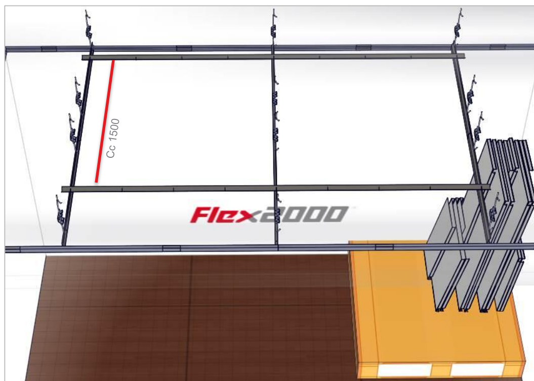
4 a. Distansprofiler cc 1500 mm på plats (sett snett ovanifrån).
